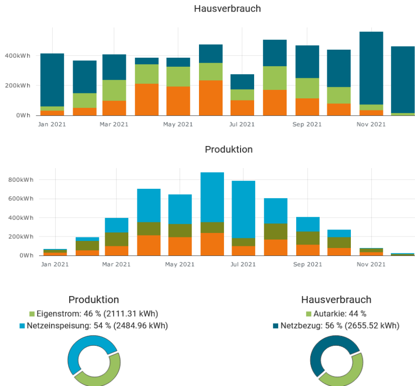
Abbildung 27: Hausverbrauch (oben) und Stromproduktion (unten) eines Einfamilienhauses (4 Personen) mit einer 6,9 kWp-PV-Anlage in Kiel. Orange zeigt den Strom der direkt verbraucht wurde, grün den Strom, der zunächst im 6 kWh-Speicher zwischengespeichert wurde, dunkelblau den Anteil von bezogenem Netzstrom, hellblau den Anteil der Netzspeisung
